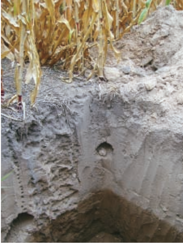
Arriba: la influencia positiva de la napa sobre los cultivos llega a través del ascenso capilar, un frente de mojado capaz de suministrar agua según la va demandando el cultivo. Derecha: Recolección con barreno de muestras de la zona saturada del perfil.
