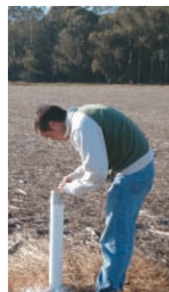
La instalación de los freatímetros bajo distintos manejos permite su monitoreo periódico a lo largo de todo el año.
