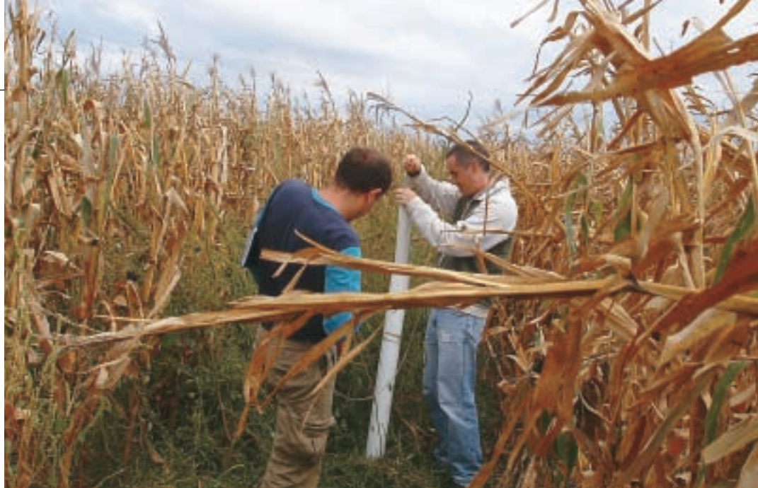
Extracción de muestra de agua (izquierda) de un freatímetro en lote agrícola. Evaluación del contenido de humedad de los perfiles de un lote en América (abajo, izquierda). Esteban Jobbagy; Sergio Buil, intendente de Rivadavia; y Daniel Trasmonte, asesor CREA (ab. der.).
